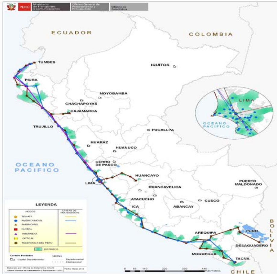
FIGURA 10. COBERTURA DE LAS REDES DE FIBRA ÓPTICA EN PERÚ
